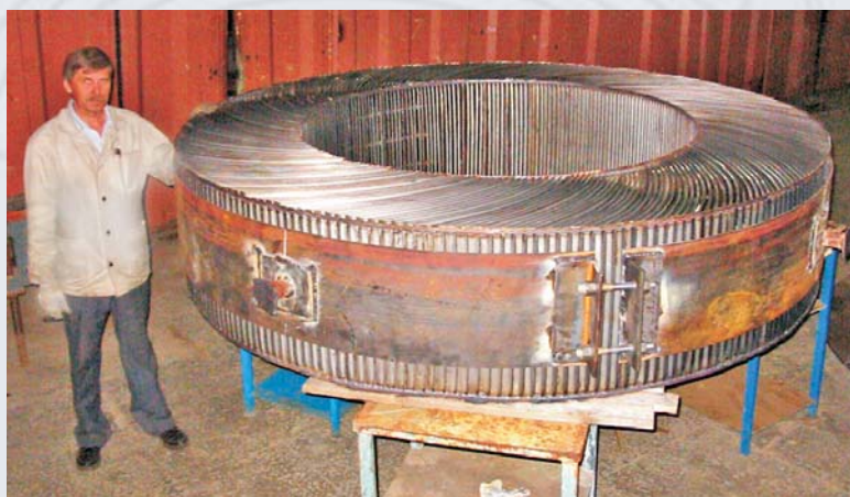
Теплообменный блок рекуператора тепла
